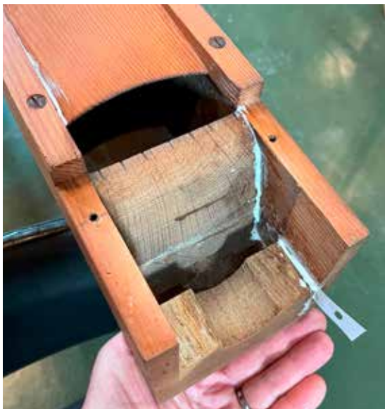
Pipan har utsatts för hög luftfuktighet, se rosten på skruvarna, och därpå för snabb upptorkning. Pipan har spruckit i överlabiet (limmas t v) och kärnan har släppt från pipkroppen (t h). Halva underdelen av pipan där pipfoten ska sitta, har lossnat och saknas på bilden. Foto: Jan Börjeson
